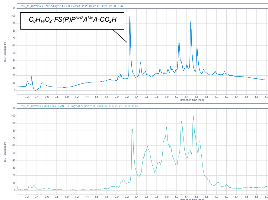
Figure 8 : Chromatogramme du peptide C_8H_{14}O_2-FS(P)P^{NH_2}A^{Me}A-CO_2H linéaire par voie de synthèse verte, t_r=2.3min
